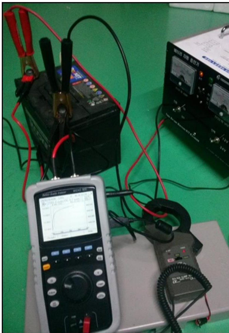
Рис. 12.0 Тест заряда/разряда АКБ подключение приборов
