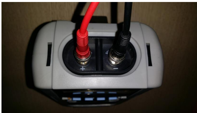
Рис. 4 - Подключение измерительных щупов к разъёмам BNC тестера.
