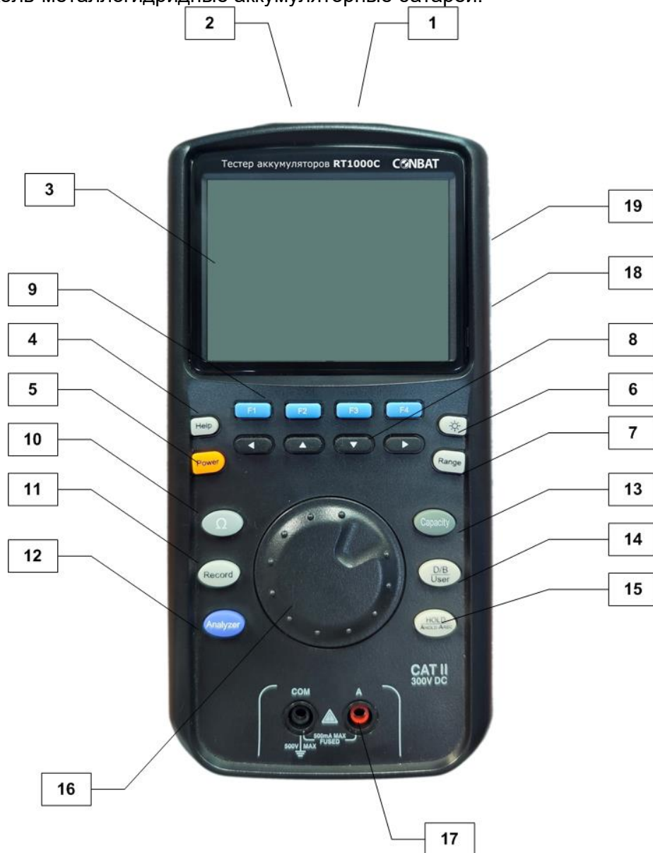
Рис. 1.2 - Назначение разъемов и кнопок тестера АКБ CONBAT мод. RT
