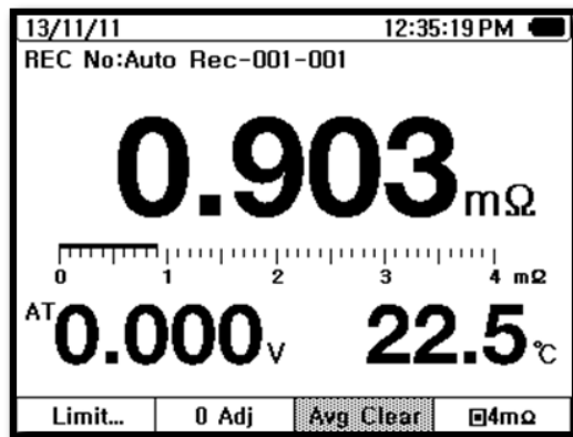
Рис. 9.1 Режим измерения сопротивления в диапазоне до 4 мΩ
